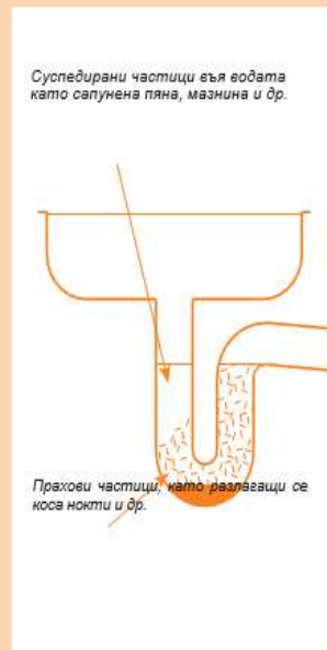
Фиг. 1. Водата в традиционните сифони може да се застои.
